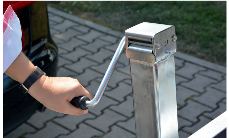
Durch Betätigen der Handkurbel wird die Kippbrücke einfach in die gewünschte Position gebracht.
