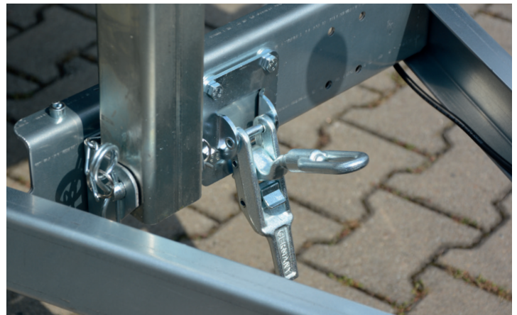
Befestigung der Kippbrücke über Sicherungsspannverschluss.
