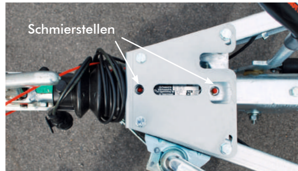
Schmierstellen der Auflaufeinrichtung
