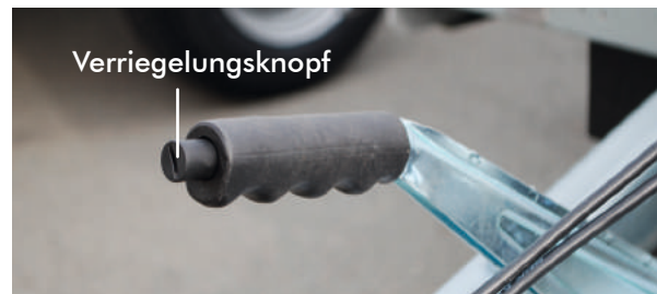
Handbremshebel mit seitlichen Zahnsegment (Abb. abweichend)
