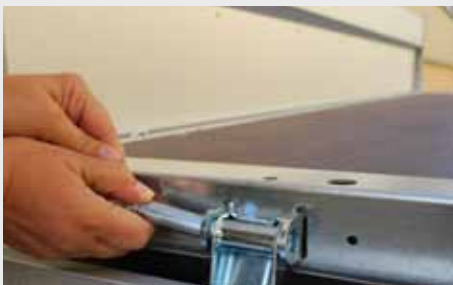
g) Scharnierbolzen einführen
