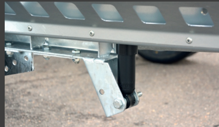
Wartungsfreie hydraulische Kippdämpfer bringen die Kippbrücke in Schräglage.
