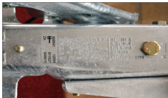
Beispiel: Aufkleber auf der Auflaufeinrichtung.
