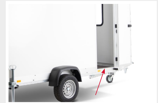
Barrierefreie Einstiegstür ohne Stolperkante
