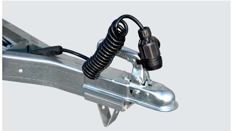
Spiralkabel mit 13-poligen Stecker für flexible Verbindung zum Zugfahrzeug (EG-Ausstattung).
