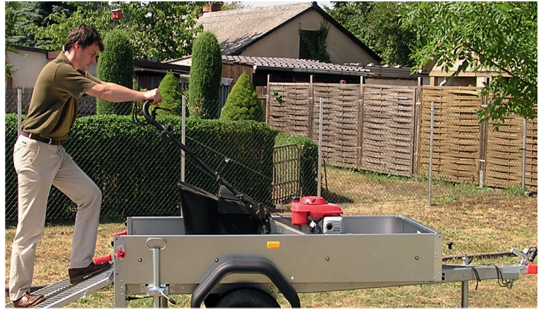
Rückwand alternativ als Auffahrrampe oder Gittersieb nutzbar
